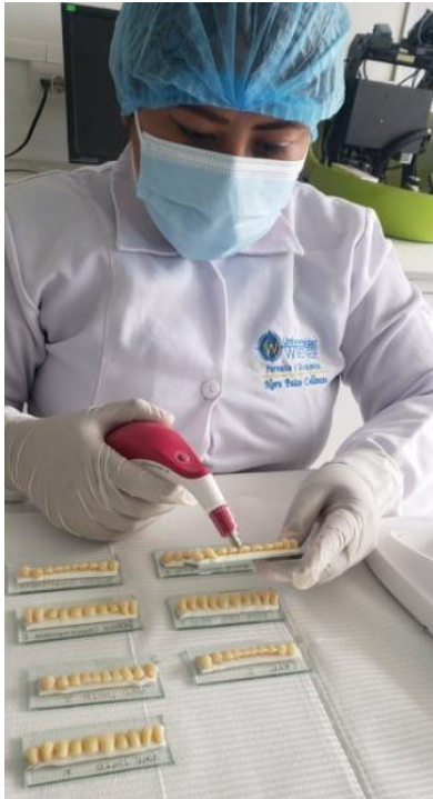
Medición a cada pieza acrílica con el espectrofotómetro VITA Easyshade
