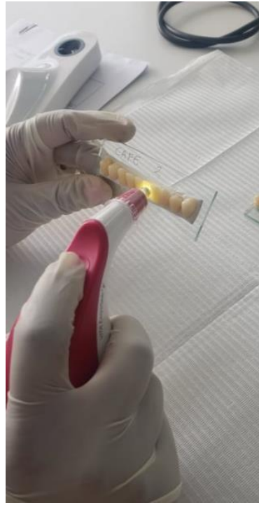
Medición a cada pieza acrílica con el espectrofotómetro VITA Easyshade
