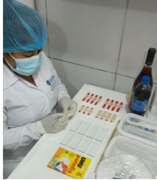
Retiro de la cera de las piezas y colocación de las piezas en la platina de vidrio.
