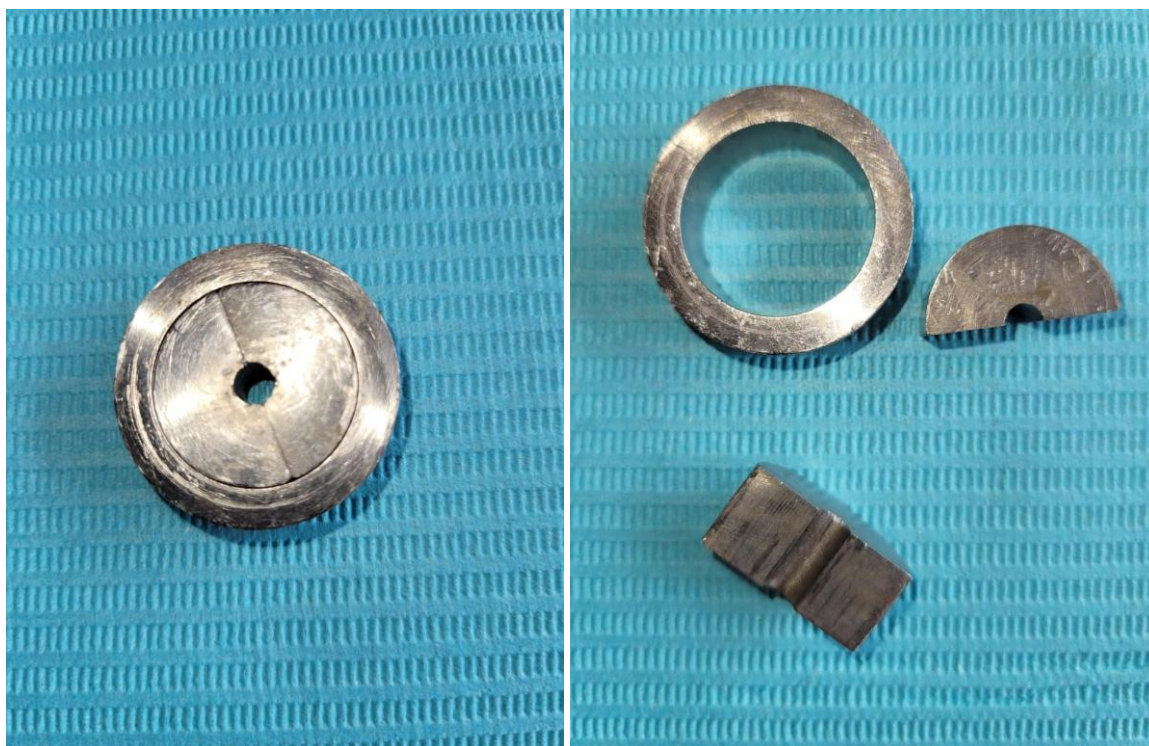
Molde metálico empleado para formación de cilindros de cada material
