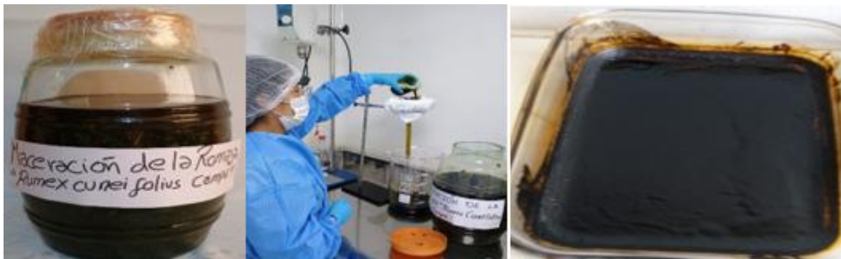
Figura 18. Proceso de la obtención del extracto seco de las hojas de romaza
