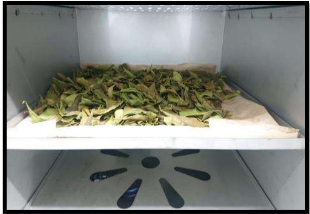
Desecado de hojas de Azadirachta indica a 50°C por 8 horas en estufa
