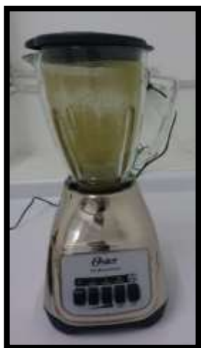
Molienda de hojas de Azadirachta indica en licuadora convencional
