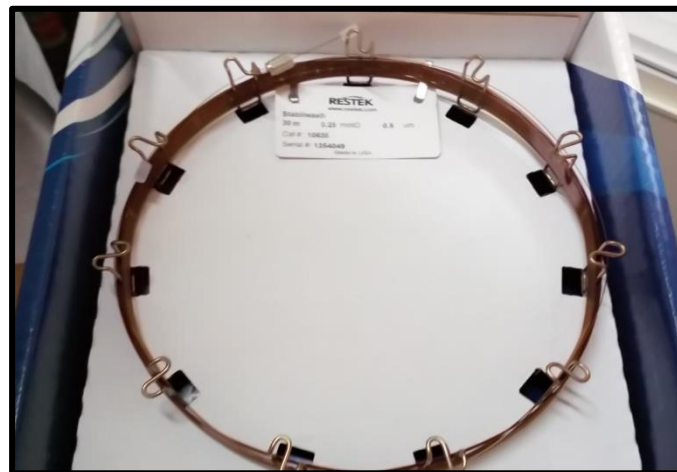
Figura 9. Columna GC: Stabilwax, 30 m, 0,25 mm ID, 0,50 µm df (cat. # 10638)
