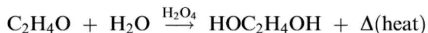
Figura 7: Tecnologías de control de emisión: proceso de control de emisión del óxido de etileno con agua en presencia de burbujeo en solución ácida y vertido de los efluentes al desagüe. Fuente: Pinto T. Control de emisión de óxido de etileno. (43)
