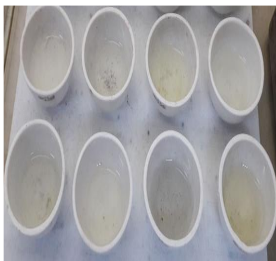
Muestras en sequedad después de digestión en plancha de calentamiento
