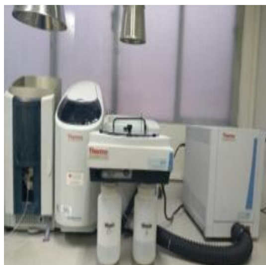
Equipo Absorción atómica, modelo THERMO SCIENTIFIC ICE 3000 equipado con horno de grafito
