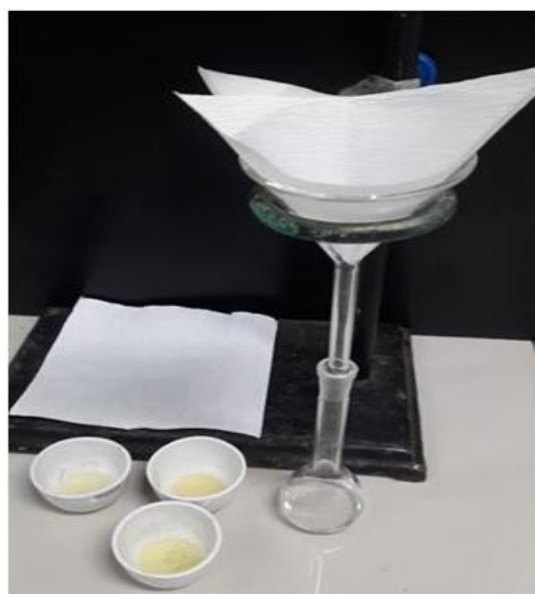
Filtración de muestras digestadas
